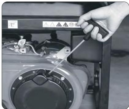
(f) После запуска двигателя, плавно верните рычаг дроссельной заслонки в положение «ОТКРЫТО» (при запуске от ручного стартера).
